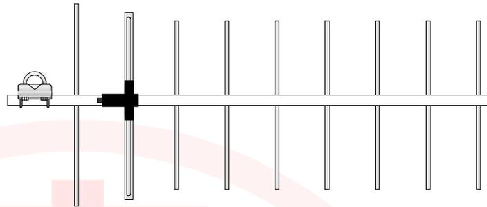
Se pueden obtener con las **D9E-350BAS** ganancias en azimut y elevación para diferentes usos, obteniendo control total sobre el lóbulo, mediante el apilamiento lado a lado y/o una encima de la otra y/o ambas, sumando en los distintos campos (horizontal y/o vertical) suficiente cantidad de
