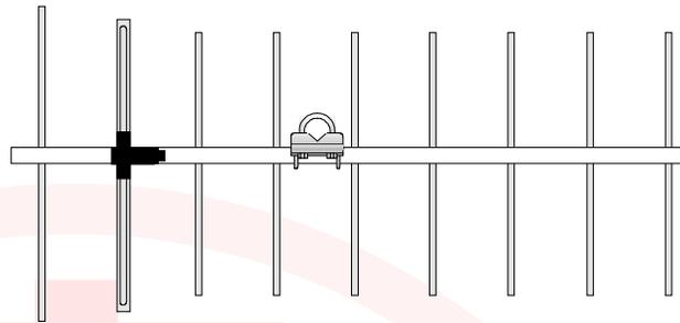
Se pueden obtener con las **D9E-250BAS** ganancias en azimut y elevación para diferentes usos, obteniendo control total sobre el lóbulo, mediante el apilamiento lado a lado y/o una encima de la otra y/o ambas, sumando en los distintos campos (horizontal y/o vertical) suficiente cantidad de
