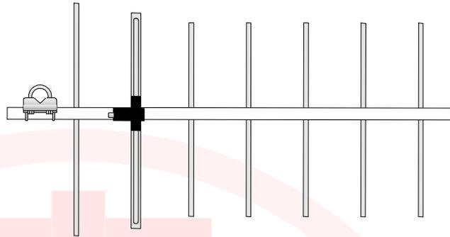
Se pueden obtener con las **D7E-350BAS** ganancias en azimut y elevación para diferentes usos, obteniendo control total sobre el lóbulo, mediante el apilamiento lado a lado y/o una encima de la otra y/o ambas, sumando en los distintos campos (horizontal y/o vertical) suficiente cantidad de
