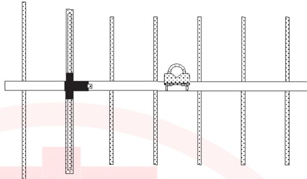
Se pueden obtener con las **D7E-150BAS** ganancias en azimut y elevación para diferentes usos, obteniendo control total sobre el lóbulo, mediante el apilamiento lado a lado y/o una encima de la otra y/o ambas, sumando en los distintos campos (horizontal y/o vertical) suficiente cantidad de
