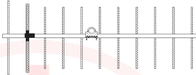
Se pueden obtener con las **D11E-150BAS** ganancias en azimut y elevación para diferentes usos, obteniendo control total sobre el lóbulo, mediante el apilamiento lado a lado y/o una encima de la otra y/o ambas, sumando en los distintos campos (horizontal y/o vertical) suficiente cantidad de
